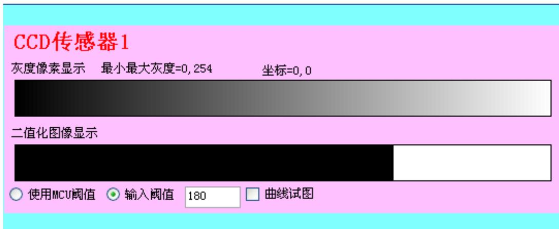
这是 1 号传感器，传感器编号从 0 开始。如图所示，可以显示灰度图像和二值化图像，显示最大和最小的灰度值，坐标第一个是横向（0~128），第二个是灰度值。只要鼠标灰度图或者二值化图像上移动，就可以看对应点出的灰度值。阈值可以手动输入，也可以使用 MCU（动态的）发回来的值，第 x 号传感器模型使用第 x 个通道的数据作为阈值。曲线显示将会吧曲线显示在示波器窗口，可以选择。
